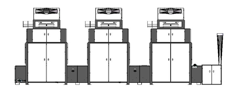
本机组集海内外业者智慧而成,专用于多组分纤维混合工艺。根据原料配比工艺要求,本机组按各种纤维预设重量值做精准定量喂入,均匀混合,使单位重量的原料所含的不同成分达到工艺要求,消除后道工序因原料混合不均匀引起的纱线色差、强度不匀等问题,从而达到高品质的均一混棉效果。本机组适用于65mm以下纯棉或棉型化学纤维,可做2-6种纤维混纺。
